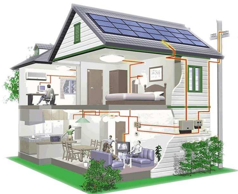
Rys. 30. Przykład domowej instalacji fotowoltaicznej (Źródło: https://pvgroup.pl/ )
